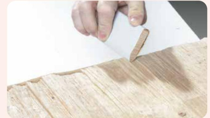
4. Enge Strukturverläufe müssen mit geeigneten Schleifpapierträgern nachgearbeitet werden.
