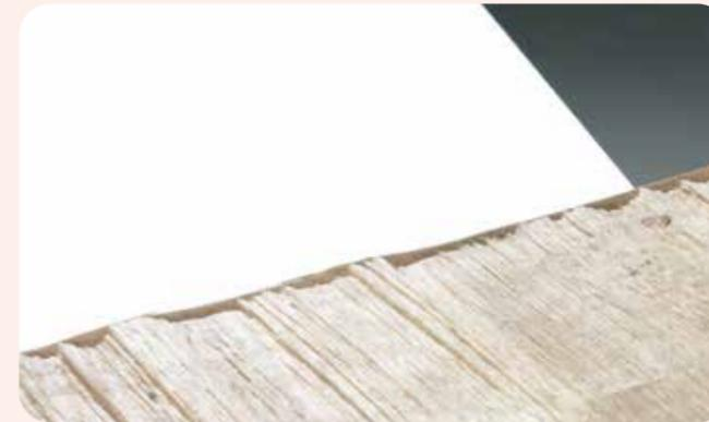
1. Kanten der Strukturplatten auf konventionellen Kantenbeschichtungsmaschinen mit ausreichend Überstand beschichten.
