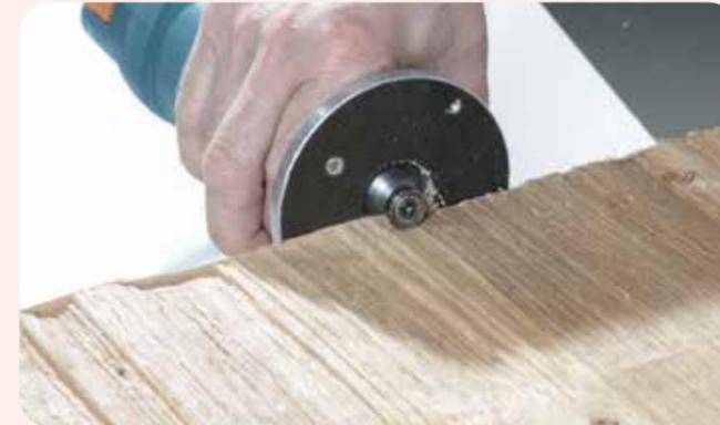
3. Fahren Sie mit dem Profilfräser möglichst waagrecht entlang der Kante und säubern das überschüssige Kantenmaterial.
