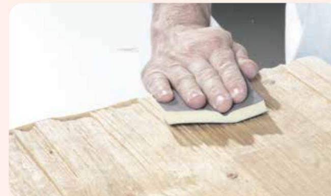
5. Kante anschließend mit Schleifschwamm (Körnung ca. 100) nacharbeiten. Dabei in Strukturaufrichtung über die Kante schleifen.
