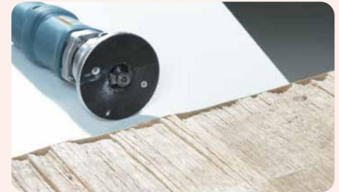
2. Überstände mit Profilfräser nacharbeiten. Es ist notwendig einen Anlaufing zur sauberen Führung zu montieren.
