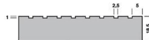
**Light** ist eine geradlinig verlaufende Struktur in Form eines Stabprofils mit Verprägungen in einem Abstand von 2,5 mm und einer Breite von 5,0 mm. Die Tiefe der Verprägung beträgt 1,0 mm.
