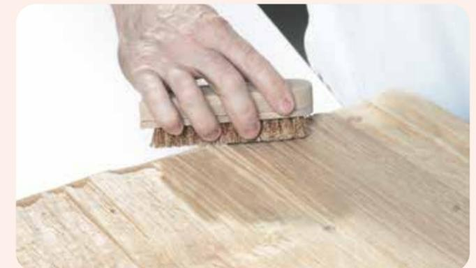
6. Struktur anschließend mit einer feinen Kupferdrahtbürste in Strukturrichtung säubern.
