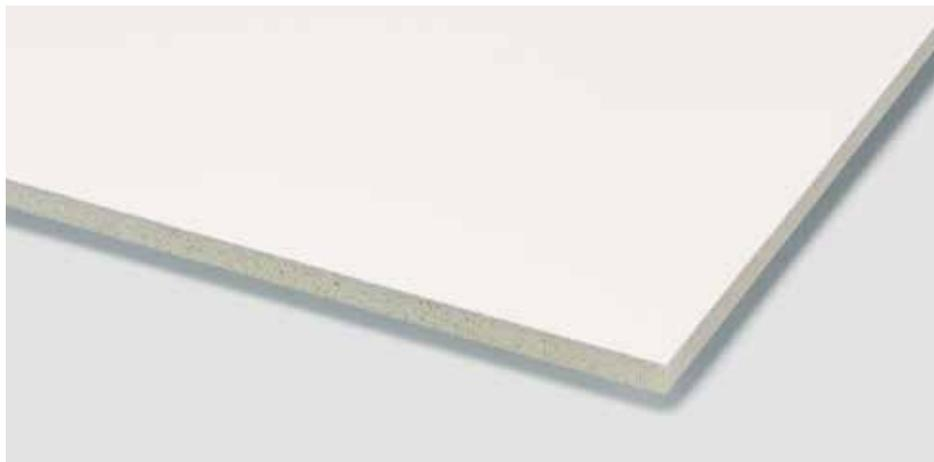
m.look System Wandschutz setzt als dekoratives mechanisch stabiles Plattenelement neue Akzente im architektonischen Bereich. Es besteht aus großformatigen m.look Platten mit hochbelastbarem Kern und mit dekorativen HPL Oberflächen an beiden Seiten nach EN 438.
