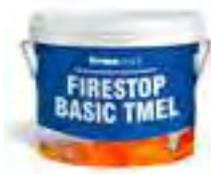
**„Firestop- Basic-Spachtelmasse“ (14 kg)** Eine brandbeständige Acrylspachtelmasse, aufgetragen mit einem breiten Spatel in die Fuge zwischen den Platten mit einem in die Spachtelmasse an der Fugenoberfläche eingelegten Versteifungsband. Eine hohe Elastizität der Spachtelmasse ist mit einer niedrigeren Schleifbarkeit verbunden. Sofern eine glatte Oberfläche herzustellen ist, ist auf die Firestop-Basic-Spachtelmasse die Firestop-Finish-Spachtelmasse aufzubringen.
