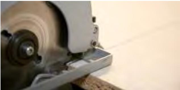
Abbildung 24: Zuschneiden mit der Handkreissäge.
