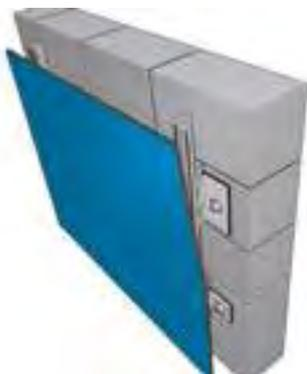
Ein weiteres Montagesystem ist die verdeckte Montage mit Hilfe von Z-Profilen, welche auf der Plattenrückseite fixiert werden. Diese Befestigungsmethode ermöglicht zudem eine schnelle Demontage der Platten ohne das Risiko der Beschädigung.
