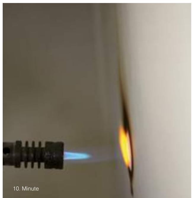
Abbildung 21 Durch die Verwendung von OSB Platten mit der Pyrotite® Oberflächenbehandlung kann die Zeit bis zur vollständigen Entzündung von ein paar Minuten bis auf Dutzende von Minuten ausgedehnt werden.
