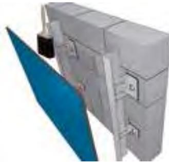
Doppelseitiges Klebeband kommt als Montagehilfe bis zur vollständigen Aushärtung des Klebers zum Einsatz. Der Kleber muss zügig, gleichmässig und durchgehend aufgebracht werden.
