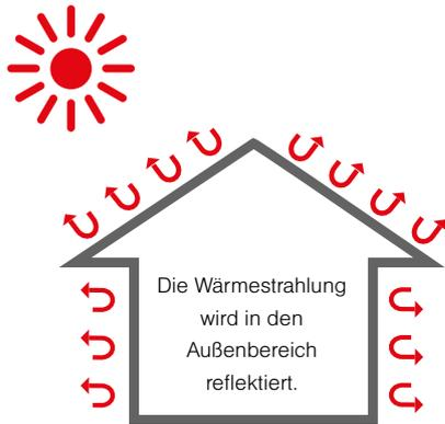
Abbildung 5 Bei schrägen und doppelschaligen Flachdächern werden die Platten als Schalung der oberen Dachkonstruktion eingesetzt. Die hochreflektierende Schicht ist in Richtung der Luftschicht orientiert.
