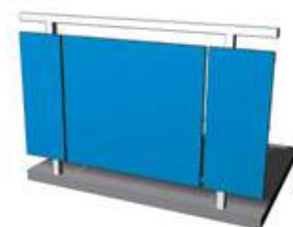
4. sichtbare Befestigung an Pfosten in Sektionen mit Z-Profilen
